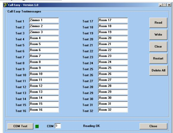
Verbinden Sie den Call Easy mit Ihrem PC und betätigen Sie die Programmier Taste auf der Rückseite. Starten sie das Programm , stellen Sie die COM Schnittstelle des Call Easy ein und klicken auf „Verbinden“.
